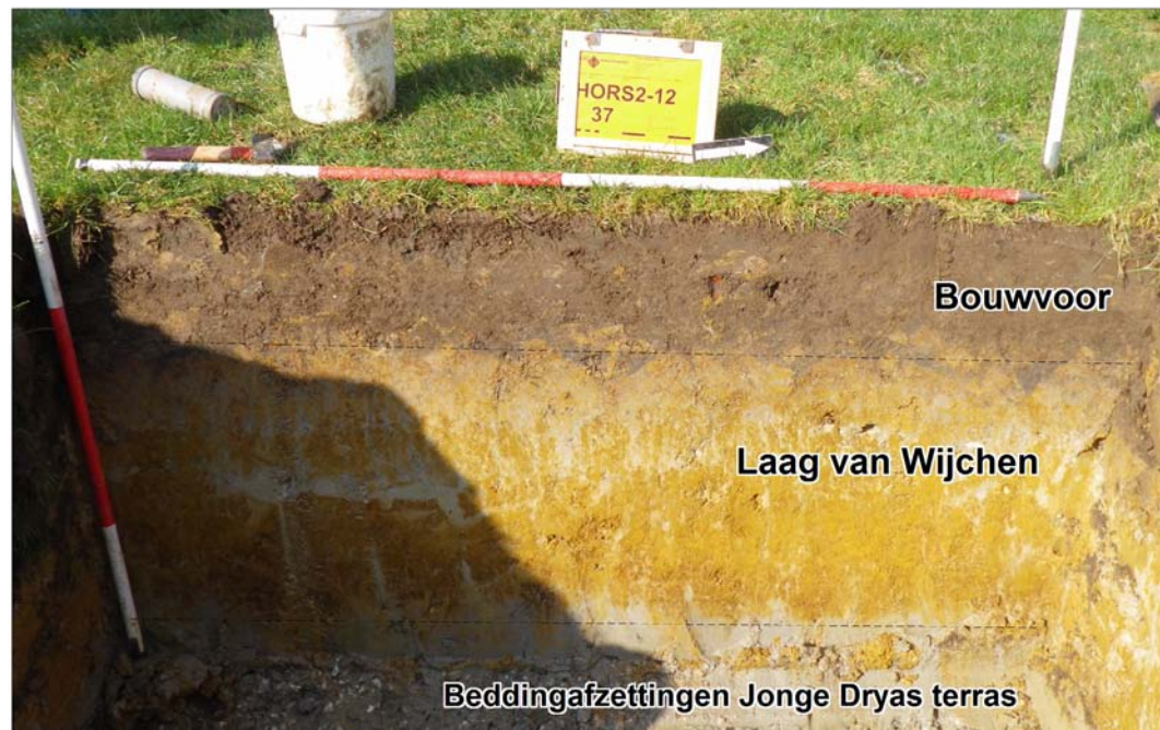
Afb. 8 Profiel proefput 33 met onderin grindrijke beddingafzettingen uit de Jonge Dryas afgedekt door laatpleistocene oeverafzettingen (Laag van Wijchen).
