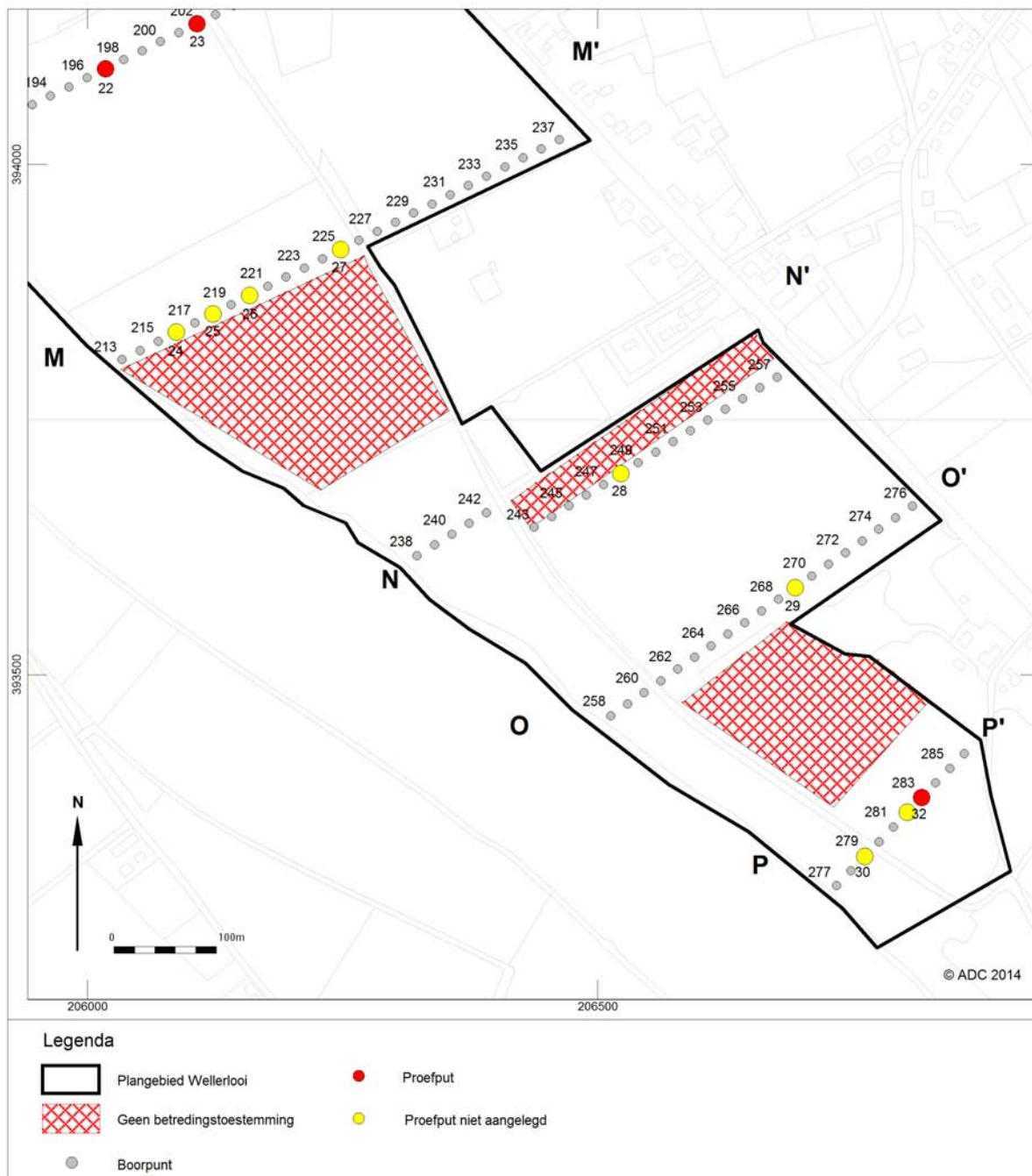
Afb. 6d Locatie van de boringen en proefputten in het zuidelijkste deel van het plangebied.
